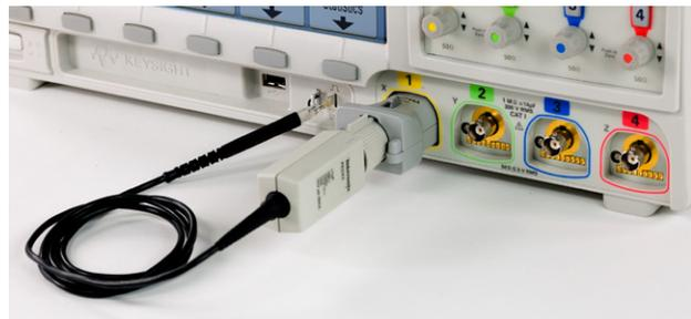
또한, N2744A T2A (키사이트 AutoProbe에 대한 Tektronix TekProbe® 인터페이스) 프로브 인터페이스 어댑터도 이용하실 수 있습니다. Tektronix TekProbe 액티브 프로브 사용자는 이 어댑터로 InfiniiVision 3000 X-시리즈 AutoProbe 인터페이스 BNC 입력에 바로 연결 가능합니다.
